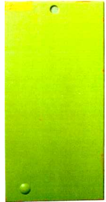
Primer No. 2 - panel No. 2 TT-E-490E topcoat.
