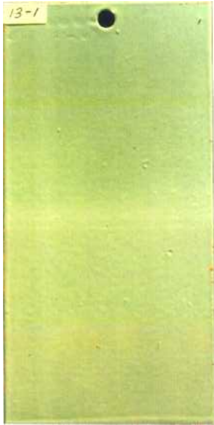
Primer No. 1 - panel No. 1 - TT-E-490E topcoat.
