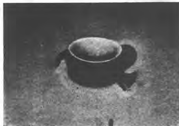
Fig. 8. - Deflusso con portata di circa 20 l/s sul calice IV ( R = 10 cm).
