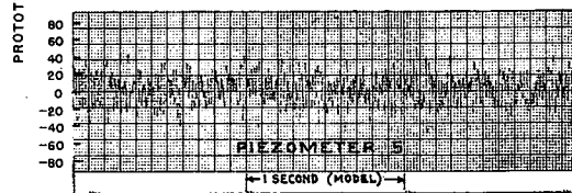
15% GATE OPENING Q=1840 C.F.S. N.T.W.=4501.4
