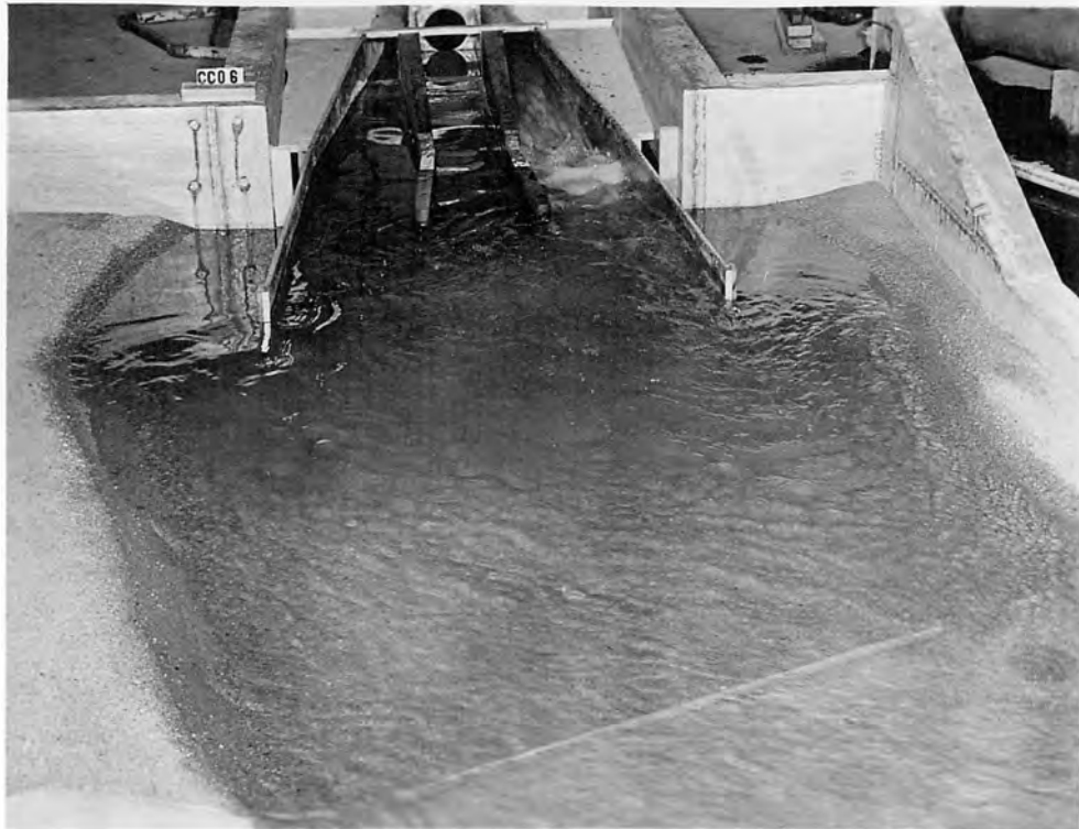
A. Left conduit discharging 2,275 second-feet
