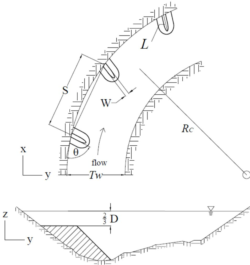
**Figure 1.** Bendway weir geometric parameter definitions
