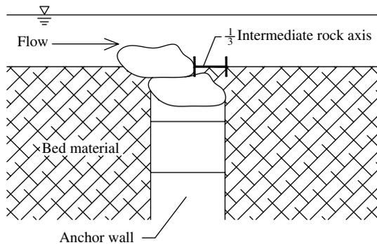
Fig. 4. Footer rock schematic
