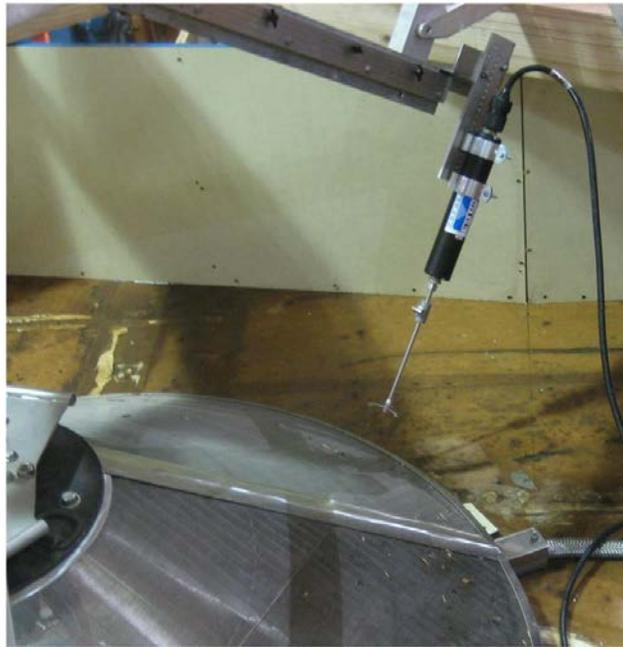
**Figure 2. SonTek ADV probe test apparatus**
